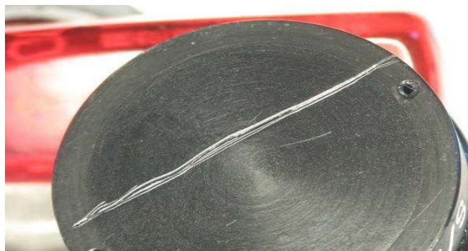
Une surface sévèrement endommagée qui mesure toujours correctement. La rayure est de 0.3mm de large et 0,2mm de profondeur
